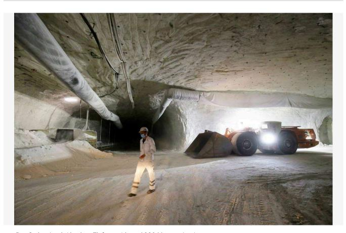
Das Steinsalz wird in einer Tiefe von bis zu 1000 Metern abgebaut.
